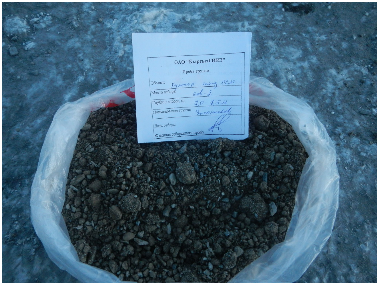
Фото №3. Проба заполнителя крупнообломочного грунта
