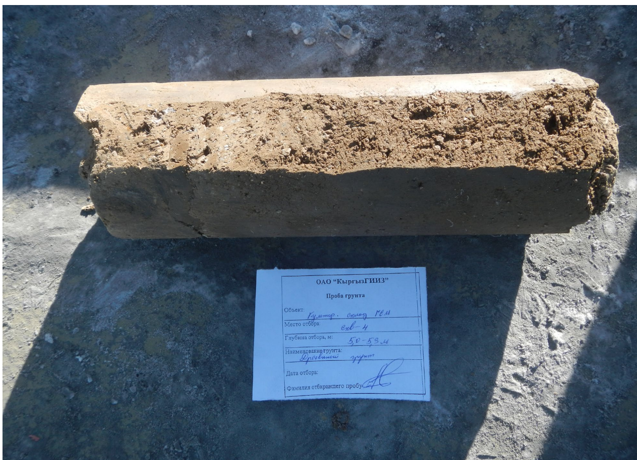
Фото №2. Отбор проб с ненарушенной структурой (монолиты)
