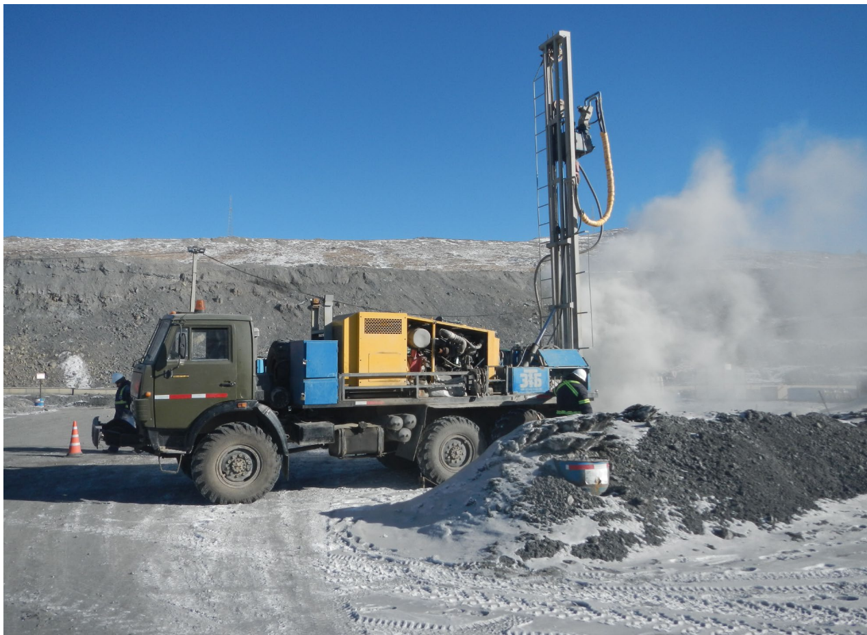
Фото №1. Бурение скважины с использованием буровой установки УРБ-2А-2
