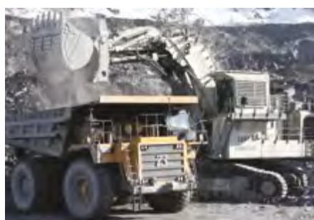
К местам взрыва после расчистки дорог подъезжают экскаваторы. На руднике работают два вида экскаваторов. Самый большой из них – Hitachi EX3600-6. Руду экскаваторы погружают на самосвалы.
