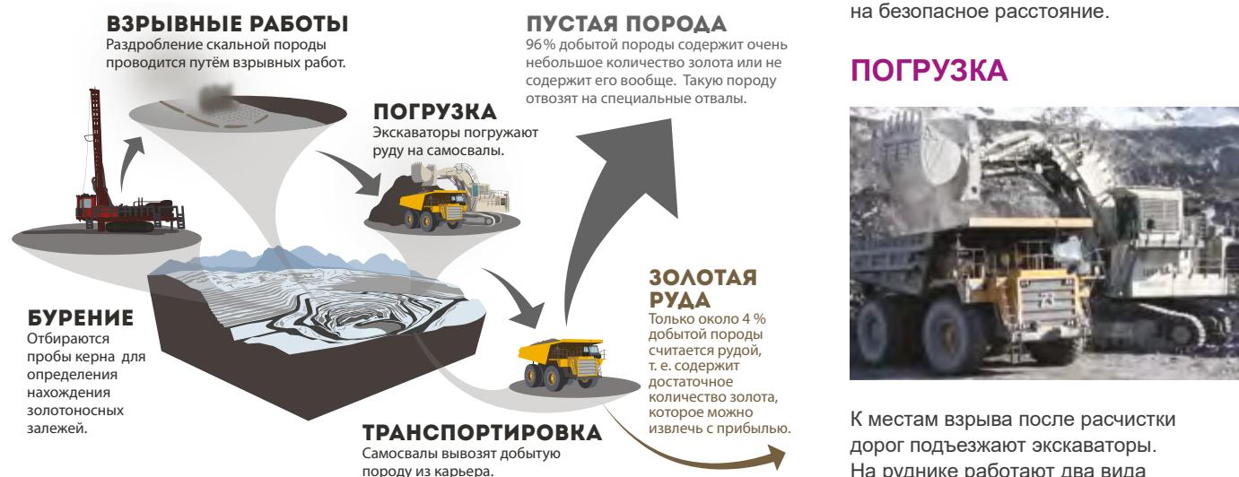
Рудник «Кумтор» оснащён самым современным парком горной техники. На карьере бесперебойно работает 99 самосвалов фирмы Caterpillar грузоподъёмностью от 145 до 185 т, 9 буровых станков и 14 экскаваторов. Для поддержания инфраструктуры в карьере также имеется вспомогательная техника – 16 бульдозеров и 11 грейдеров. Людей на рудник доставляют на КамАЗах, или, как их называют в народе, вахтовках.
