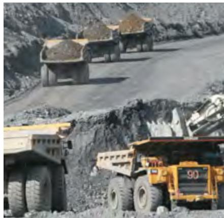
Для того чтобы достичь золотосодержащей руды, необходимо провести масштабные вскрышные работы, то есть буквально снять слой пустой породы. Самосвалы, транспортирующие пустую породу, выгружают её на специальных отвалах. Самосвалы, перевозящие золотосодержащую руду, следуют по другому маршруту – везут руду на дробилку, где она перемалывается до приемлемых размеров и далее по конвейеру поступает на фабрику.
