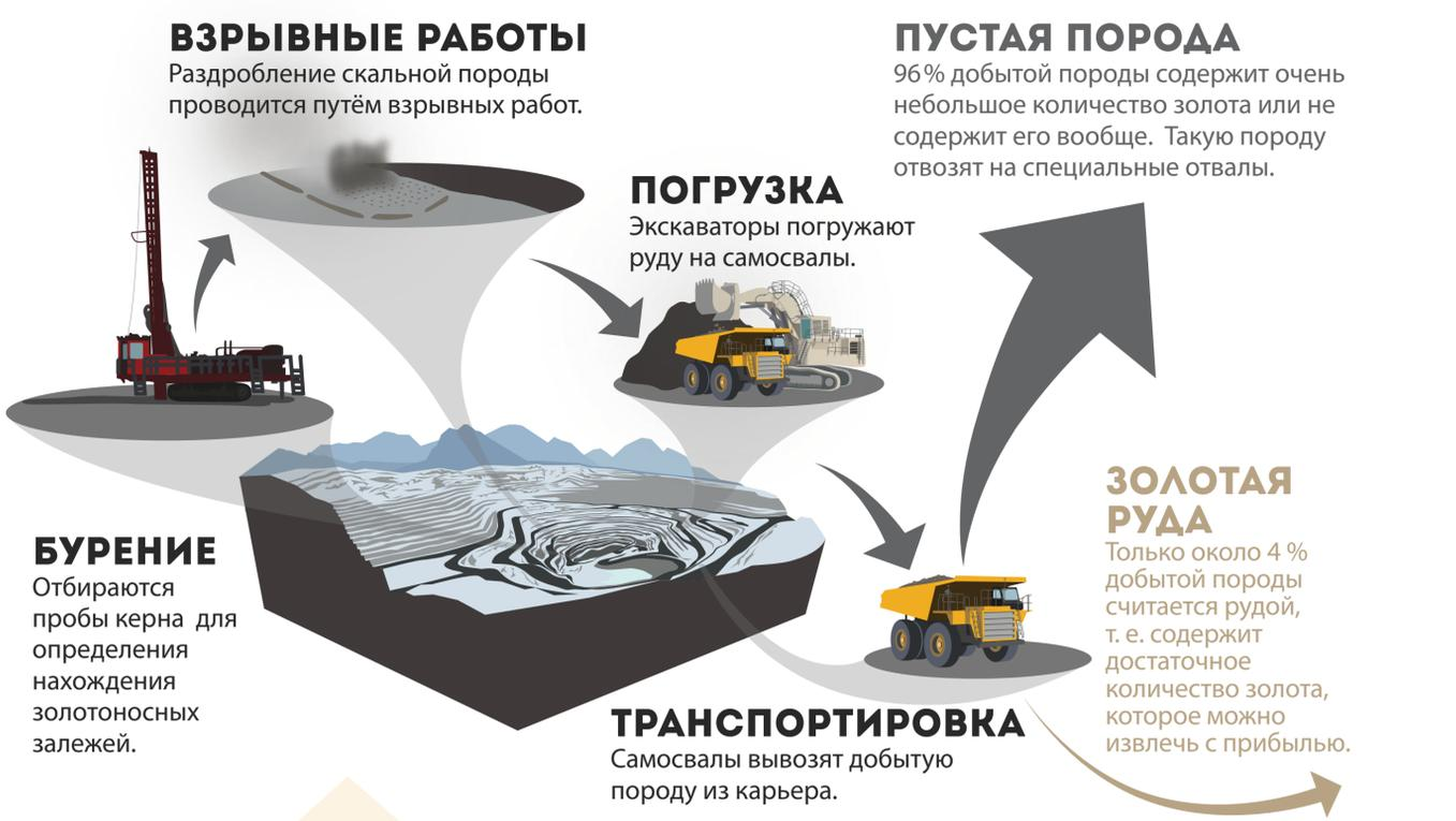
Рудник Кумтор оснащён самым современным парком горной техники. На карьере бесперебойно работает 99 самосвалов фирмы Caterpillar грузоподъёмностью от 145 до 185 т, 9 буровых станков и 14 экскаваторов.
