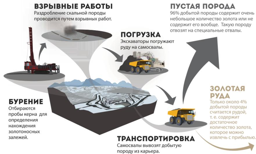
Рудник «Кумтор» оснащен самым современным парком горной техники. На карьере бесперебойно работает 103 самосвала фирмы Caterpillar грузоподъемностью от 145 до 185 тонн, 8 буровых станков и 14 экскаваторов. Для поддержания инфраструктуры в карьере также имеется вспомогательная техника – бульдозеры и грейдеры. Всего на руднике работают 14 бульдозеров и 11 грейдеров. Людей на карьер доставляют на КАМАЗах или, как их называют в народе, вахтовках.
