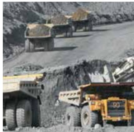
Для того, чтобы достичь золотосодержащей руды, нужно провести масштабные вскрышные работы. То есть буквально снять слой пустой породы. Поэтому самосвалы, транспортирующие пустую породу, выгружают ее на специальных отвалах. В свою очередь, самосвалы, перевозящие золотосодержащую руду, следуют другому маршруту – везут руду на дробилку. На дробилке руда перемалывается до приемлемых размеров и далее по ленте поступает на фабрику.
