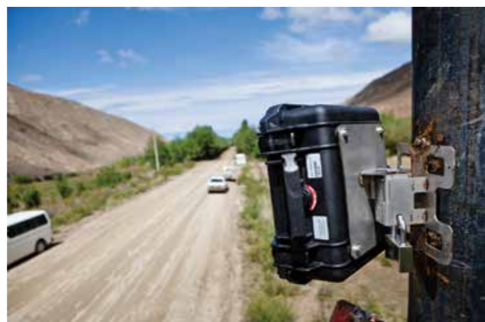
Измерительный прибор фиксирует данные по количеству проезжающих машин, их габаритам и направлению их движения.
