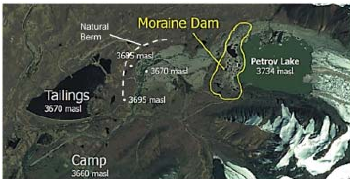
Рисунок 4: Расположение естественной моренной дамбы озера Петрова и хвостохранилища Кумтор (мнум = метры над уровнем моря, источник: приведен из отчета «BGC», 2012г.)
